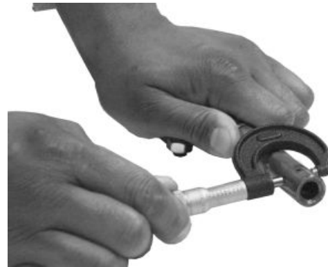
Rocker Arm Shaft OD
